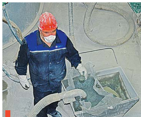
Взятие пробы шликера с участка мокрого помола
